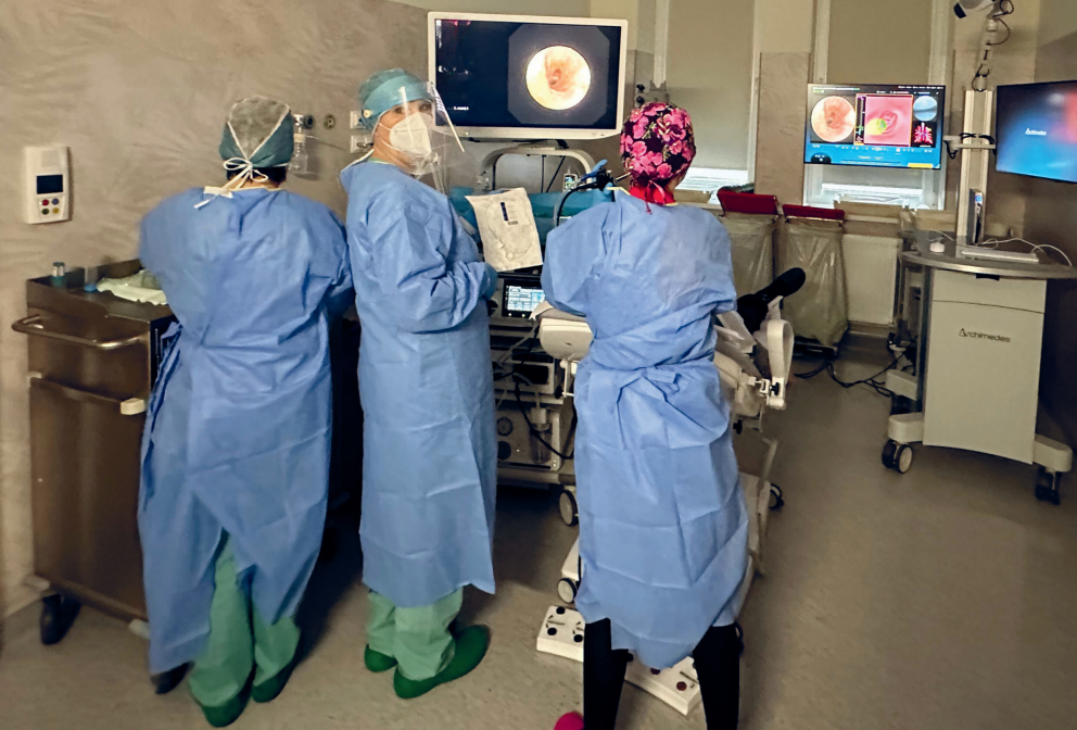
Archimedes podczas wykonywania bronchoskopii. Sprzęt widoczny po prawej stronie: na monitorze wyświetla się obraz na żywo z endoskopu i równocześnie wizualizacja stworzona przez system
